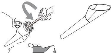
**Figura 4-3. Abertura de llenado de aceite con embudo**
