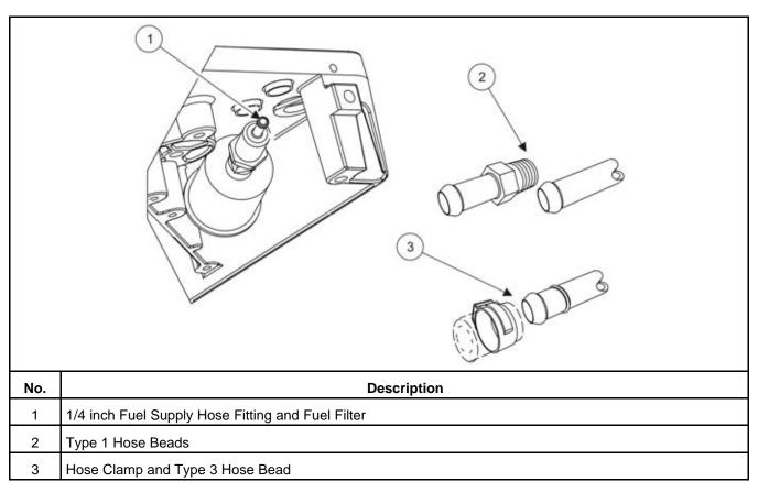
FIGURE 15. GASOLINE MOTORIZED FUEL CONNECTION
