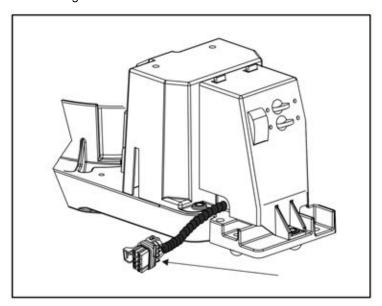
FIGURE 28. REMOTE CONTROL CONNECTOR
