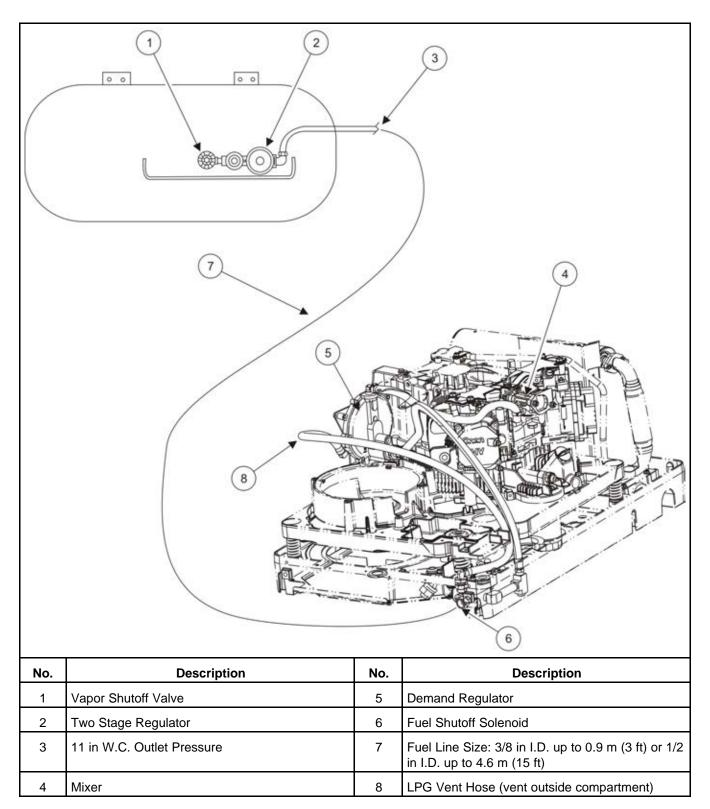
FIGURE 25. TYPICAL LPG VAPOR WITHDRAWAL FUEL SYSTEM
