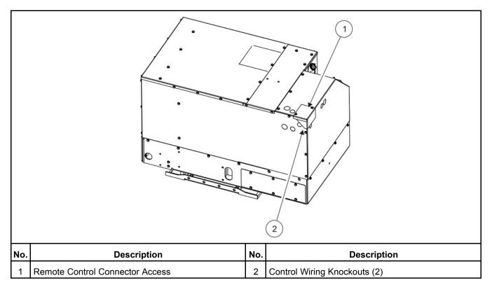
FIGURE 12. REMOTE CONTROL CONNECTOR
