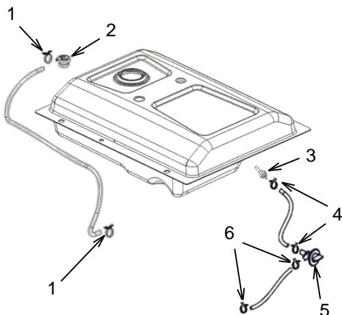
Vidangez le réservoir de carburant dans un récipient adapté. Démarrez le moteur et laissez-le tourner jusqu'à ce qu'il soit à court de carburant. Tournez le commutateur du générateur en position « 0 » (désactivée).
