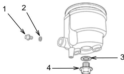
Drene el combustible de la cámara del flotador retirando el tornillo del orificio de drenado (1) y la junta (2). Use un recipiente adecuado para recibir el combustible. Deseche el combustible adecuadamente. Retire el tornillo (4) y la junta (3). Cuidadosamente retire la cámara del flotador, evitando que caiga cualquier pieza pequeña.
