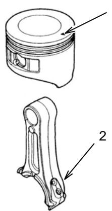
Coloque la biela en el pistón de modo que el lado más largo de la biela (2) quede alineado con la marca en la cabeza del pistón (1). Inserte por un lado del pistón, a través de la biela, y después a través del otro lado del pistón.
