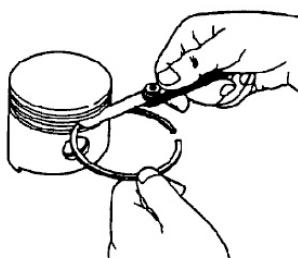
Mesurez le jeu de la bague, comme illustré. Pour le modèle RP5500, le jeu normal doit être compris entre 0,015 et 0,045 mm. Pour les modèles RP6500E et RP7500E, le jeu normal doit être
