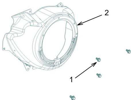
Retire los tornillos (1) y la envoltura (2).
