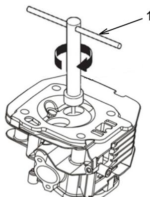
Si l'enduit à marquer montre que le siège de soupape n'est pas concentrique, utilisez une lame de découpe pour siège de soupape à 45° (1) pour créer un siège lisse et concentrique.
