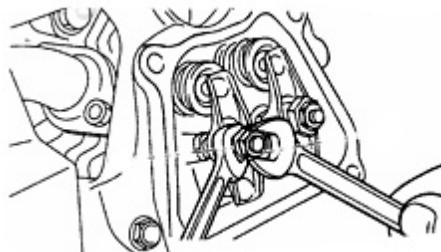
Afloje la contratuerca. Gire la tuerca de ajuste en el sentido de las manecillas del reloj para disminuir la holgura. Gire la tuerca de ajuste en sentido contrario a las manecillas del reloj para aumentar la holgura. Cuando la holgura de la válvula llegue al margen de tolerancia, apriete la contratuerca a  $8\pm1$  N·m ( $6\pm1$  lb ft). Vuelva a colocar la junta de la tapa de la válvula y la tapa de la válvula. Compruebe que la arandela de la
