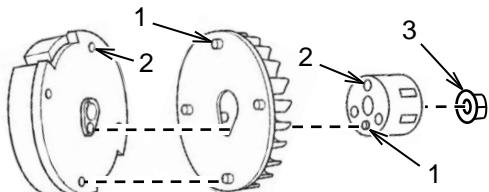
Alinee los pernos de posicionamiento (1) de la copa de arranque y de ambos lados del impulsor con los orificios (2) de la copa de arranque y del volante de inercia. Coloque el conjunto en el cigüeñal. Asegure el conjunto al cigüeñal con tuercas (3). Apriete la tuerca a  $95 \pm 4$  N·m ( $70 \pm 3$  lbft).
