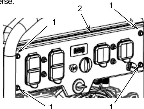
Retirez les boulons (1) et les rondelles. Tirez lentement le panneau de commande (2) vers l'avant. Vérifiez que les câbles peuvent bouger librement et ne sont pas endommagés. Marquez les câbles pour les identifier, puis débranchez les faisceaux de câbles.
