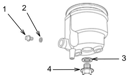
Coloque el tapón del orificio de drenado (1) y la junta (2) en la cámara del flotador. Coloque la cámara del flotador en su lugar para que se pueda tener acceso al tornillo del orificio de drenado desde fuera de la unidad. Coloque la junta (3) y el tornillo (4) para fijar la cámara del flotador en su lugar.
