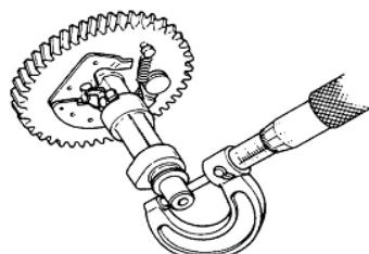
Mida el diámetro exterior del árbol de levas. Los límites aceptables para el diámetro se muestran en la siguiente tabla. Si el diámetro está fuera del rango aceptable, reemplace el árbol de levas.
