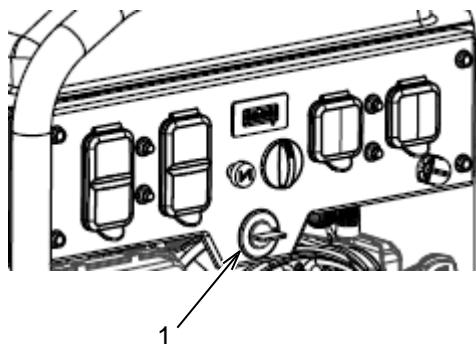
Il est possible d'accéder au robinet de carburant (1) sans retirer le panneau de commande. Pour retirer le robinet de carburant, vidangez le réservoir de carburant dans un récipient adapté. Démarrez le moteur et laissez-le tourner jusqu'à ce qu'il soit à court de carburant. Tournez le commutateur du générateur en position « 0 » (désactivée).
