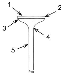
Revise las válvulas en busca de daño. Revise la cabeza de la válvula (1), la orilla de la válvula (2) y la cara de la válvula (3) en busca de áreas dañadas o quemadas. Revise el cuello de la válvula (4) en busca de desgaste inusual. Revise el vástago de la válvula (5) en busca de desgaste, marcas o dobleces. Si encuentra algún daño, reemplace la válvula.
