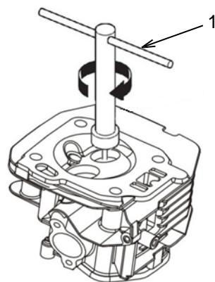
Si el compuesto empleado para dejar marcas muestra que el asiento de la válvula no es concéntrico, use un cortador de asiento de válvula de 45° (1) para crear un asiento liso y concéntrico. Siempre gire el cortador en el sentido de las manecillas del reloj. Use el
