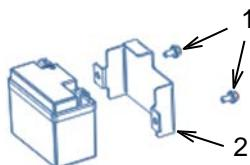
Débranchez le câble de la borne négative de la batterie et placez-le loin de la batterie pour éviter tout contact. Débranchez le câble positif de la batterie. Utilisez un voltmètre ou un multimètre réglé sur V c.c. pour mesurer la tension de la batterie. Si la batterie fournit moins de 12,4 volts, remplacez-la. Retirez les boulons (1) et la plaque (2). Retirez la batterie et éliminez-la de manière appropriée.
