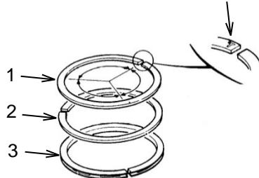
Los anillos del pistón tienen una marca junto a la abertura. Use un extractor de anillo para instalar los anillos con la marca mirando hacia arriba del pistón. Asegúrese de instalar los anillos en las ranuras correctas, con el anillo de
