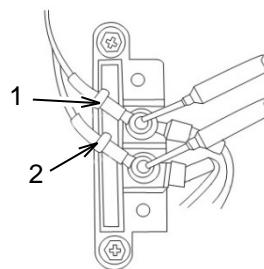
En el bloque de terminales, use un ohmímetro o multímetro para medir la resistencia del devanado principal. Coloque el medidor entre el cable blanco (1) y el cable café (2). La resistencia debe ser de  $0.35 \Omega \pm 10\%$  a  $25^\circ\text{C}$ . Si la resistencia está fuera del margen de tolerancia, reemplace el generador. Mida la resistencia de los cables a la conexión a tierra. La resistencia debe ser infinita. Si la resistencia no es infinita, reemplace el generador.
