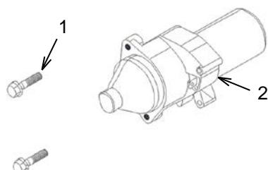
Retire los pernos de montaje del arrancador (1) de la parte frontal del cárter y desprenda el arrancador (2) de la parte lateral del cárter. Vuelva a instalarlo en orden inverso.
