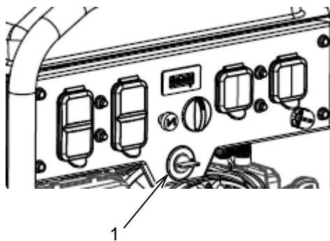
Se puede acceder a la válvula de combustible (1) sin retirar el panel de control. Para retirar la válvula de combustible, drene en un contenedor adecuado el combustible del depósito de combustible. Encienda el motor y deje que se agote el combustible. Coloque el interruptor del generador en la posición de apagado "0".
