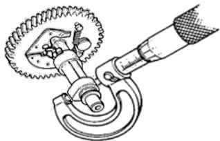
Vérifiez que l'arbre à cames n'a pas subi de dommages ni d'usure inhabituelle. Mesurez la levée des lobes de l'arbre à cames. Les limites acceptables de levée sont répertoriées dans le tableau ci-dessous. Si la levée est en dehors de la plage acceptable, remplacez l'arbre à cames.
