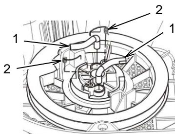
Coloque las levas de impulsión de arranque (1) en la polea del arrancador retráctil e instale los resortes de retorno (2) en la polea y engáncielos en el lado de las levas de impulsión.
