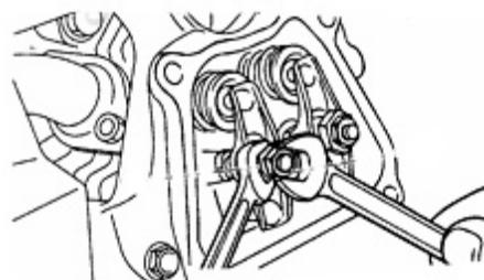
Desserrez l'écrou de verrouillage. Tournez l'écrou de réglage dans le sens des aiguilles d'une montre pour réduire l'écart. Tournez l'écrou de réglage dans le sens inverse des aiguilles d'une montre pour augmenter l'écart. Quand le jeu de la soupape se trouve dans la marge de la tolérance,
