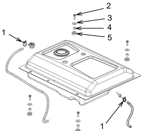
Retirez les colliers de serrage (1) et les conduites d'alimentation en carburant du capteur de retournement et du filtre à carburant. Retirez les quatre boulons (2), les rondelles (3), les bagues (4) et les manchons (5). Soulevez le réservoir de carburant.
