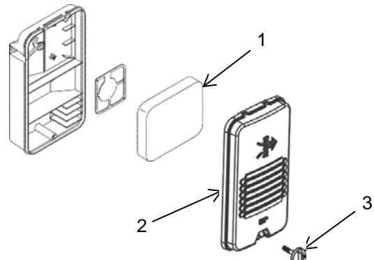
Retirez le boulon du couvercle du filtre à air (3), puis retirez le couvercle du filtre à air (2). Vérifiez que le filtre à air (1) est propre et non endommagé. Si le filtre à air est sale, lavez-le. Si le filtre à air est endommagé, remplacez-le.
