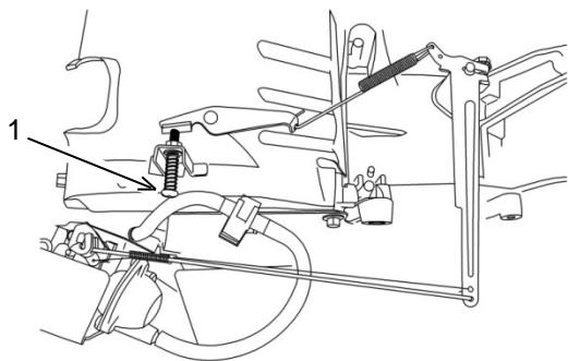
Le régime maximal de ce moteur est de 3 730 à 3 830 tr/min. Faites tourner la vis de réglage (1) dans le sens horaire pour augmenter le régime. Faites tourner la vis de réglage dans le sens anti-horaire pour diminuer le régime.
