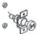
El control del estrangulador está fijado a la parte trasera del panel mediante tuercas de 7 mm. Retire la perilla y el cable del estrangulador de la parte frontal del panel, y retire las tuercas que sostienen el estrangulador al panel. Retire el control del estrangulador de la parte trasera del panel. Vuelva a instalar en orden inverso.
