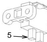
Revise la longitud de las escobillas (5). Si la longitud es 6 mm o menos, reemplace la escobilla. Para retirar la escobilla, quite el tornillo (1) y desconecte los cables. Para reinstalarla, conecte el cable rojo a la terminal "+", el cable blanco a la terminal "-", use el tornillo (1) para asegurar la nueva escobilla.
