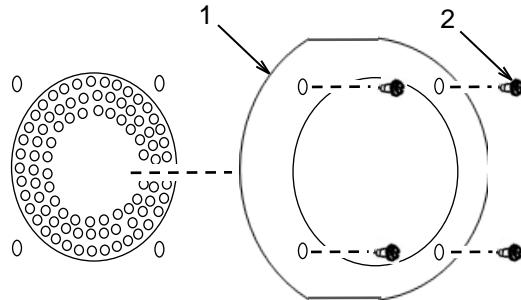
Quite los tornillos (2). Quite el apagachispas (1) y compruébelo. Limpie con cuidado el apagachispas utilizando un cepillo de alambre suave. Reemplace el apagachispas si está dañado.
