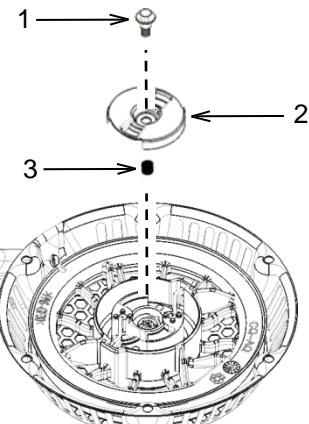
Installez le ressort (3), le guide d'entraînement (2), et la vis de fixation (1). Serrez la vis de fixation à  $9 \pm 1 \text{ N m}$  (6-7 lb pi).
