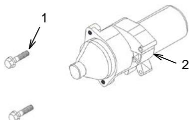
Retirez les boulons de fixation du démarreur (1) de l'avant du carter moteur et retirez le démarreur (2) du côté du carter. Remontez les pièces dans l'ordre inverse.
