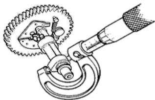
Inspeccione el árbol de levas en busca de daños o desgaste anormal. Mida el levantamiento en los lóbulos del árbol de levas. Los límites aceptables para el levantamiento se muestran en la siguiente tabla. Si el levantamiento está fuera del rango aceptable, reemplace el árbol de levas.
