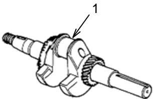
Revise el diámetro del muñón del cigüeñal (1). Un diámetro normal es de 29.975 a 29.991 mm. Si el diámetro es de 29.92 mm o menos, reemplace el cigüeñal.
