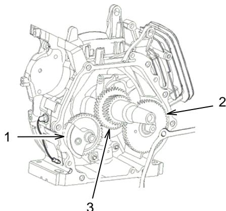
El motor tiene tres ejes, el eje de balanceo (1), el árbol de levas (2) y el cigüeñal (3).
