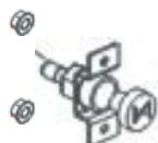
La commande de l'étrangleur est fixée à l'arrière du panneau à l'aide d'écrous de 7 mm. Retirez le bouton et le câble de l'étrangleur de la partie avant du panneau, puis retirez les écrous qui fixent l'étrangleur au panneau. Retirez la commande de l'étrangleur de l'arrière du panneau. Remontez les pièces dans l'ordre inverse.
