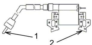
Mida la resistencia de la bobina secundaria haciendo tocar uno de los cables de un ohmímetro al cable de la bujía (1) y haciendo tocar el otro cable al marco de metal (2). Para el RP5500 la resistencia debe ser de 5.6 – 6.6 kΩ. Para el RP6500E y RP7500E la resistencia debe ser de 5.9 – 7.1 kΩ. Si la resistencia no está dentro del rango apropiado, reemplace la bobina.
