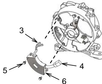
Desconecte los cables (3) de la escobilla y desenchufe el conector (4). Retire los tornillos (5) y el regulador de voltaje (6). Vuelva a instalarlo en orden inverso. Los cables rojos van en la terminal "+" de la escobilla. Los cables blancos van en la terminal "-" de la escobilla.
