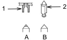
Vérifiez toute trace d'usure sur le pointeau de carburateur (2) et son siège (1). La figure A montre un pointeau de carburateur usé qui a besoin d'être remplacé. La figure B montre un pointeau de carburateur qui peut être réutilisé.
