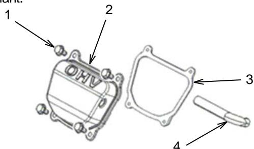
Retirez les boulons du couvercle de la soupape (1), le tube du reniflard (4), le couvercle de la soupape (2) et la rondelle du couvercle de la soupape (3).
