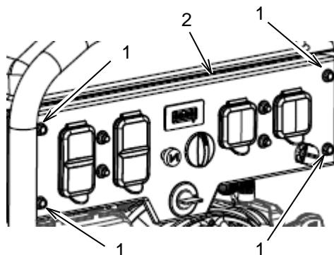
Retire los tornillos (1) y las arandelas. Jale el panel de control (2) lentamente hacia adelante. Asegúrese de que los cables se mueven libremente y no están dañados. Etiquete los cables para identificarlos y después desconecte el cableado eléctrico.
