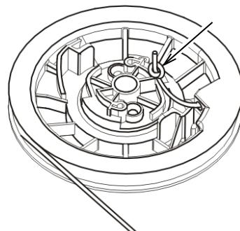
Pase el cable del arrancador retráctil a través del agujero en la polea del arrancador y haga un nudo al final de la cuerda como se muestra a continuación.
