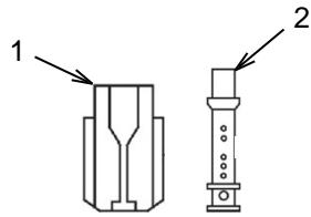
Inspectez le gicleur principal de carburant (1) et l'injecteur principal de carburant (2). Remplacez-les en cas d'usure.
