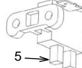
Vérifiez la longueur des brosses (5). Remplacez-la si la longueur est inférieure ou égale à 6 mm. Pour enlever la brosse, retirez les boulons (1) et débranchez les fils. Pour procéder à la réinstallation, branchez le fil rouge à la borne « + » et le fil blanc à la borne « - », puis fixez la nouvelle brosse à l'aide d'un boulon (1).
