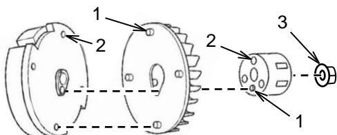
Alignez les goupilles de positionnement (1) de la coupelle de démarreur et des deux côtés de la roue à ailettes sur les trous (2) de la coupelle de démarreur et du volant d'inertie. Placez le système sur le vilebrequin. Fixez le système sur le vilebrequin à l'aide d'un écrou (3). Serrez l'écrou à  $95 \pm 4$  N m ( $70 \pm 3$  lb pi).
