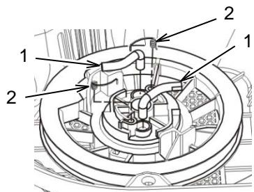
Réglez les cames d'entraînement du démarreur (1) sur la poulie du démarreur manuel, installez les ressorts de rappel (2) sur la poulie et accrochez-les sur le côté des cames d'entraînement.
