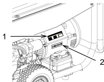
Les génératrices portables Cat sont identifiées à l'aide d'un numéro de modèle, d'un numéro de série et d'un numéro de caractéristiques de performances. Le numéro de modèle et les caractéristiques de performances se trouvent sur la plaque signalétique (1). Le numéro de série se trouve sur la plaque du numéro de série (2).
