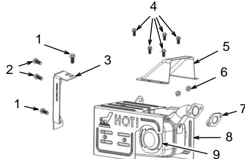
Dévissez les boulons (1) et (2), puis retirez le support (3). Dévissez les boulons (4), puis retirez le couvercle (5). Retirez les écrous (6) et soulevez le silencieux (8) des goujons de montage. Jetez le joint usagé (7). Il n'est pas recommandé de retirer le couvercle du silencieux. Réinstallez en suivant l'ordre inverse et en utilisant un nouveau joint (7). Pour l'entretien du pare-étincelles, consultez la section Pare-étincelles – Inspection/Nettoyage/Remplacement.
