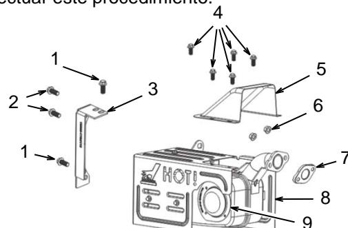
Retire los tornillos (1) y (2) y retire el soporte (3). Retire los tornillos (4) y la cubierta (5). Retire las tuercas (6) y levante el silenciador (8) para desprenderlo de los pasadores de montaje. Deseche las juntas usadas (7). No se recomienda retirar la cubierta del silenciador. Vuelva a instalarlo en orden inverso usando una junta nueva (7). Para dar servicio al apagachispas, consulte el apartado "Inspección/limpieza/ sustitución del apagachispas".
