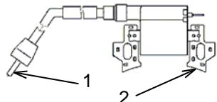
Mesurez la résistance de la bobine secondaire en connectant un fil d'un ohmmètre au câble de bougie (1) et en connectant l'autre fil au châssis métallique (2). Pour le modèle RP5500, la résistance doit être comprise entre 5,6 et 6,6 Ω. Pour les modèles RP6500E et RP7500E, la résistance doit être comprise entre 5,9 et 7,1 Ω. Si la résistance est en dehors de la plage adaptée, remplacez la bobine.
