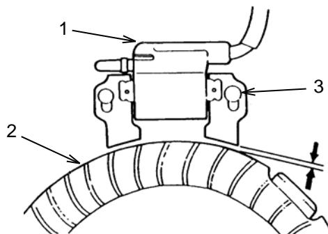
Use una galga de espesores para medir la distancia entre la bobina de arranque (1) y el volante de inercia (2). Para el RP5500 la distancia debe ser de 0.2 – 0.6 mm. Para el
