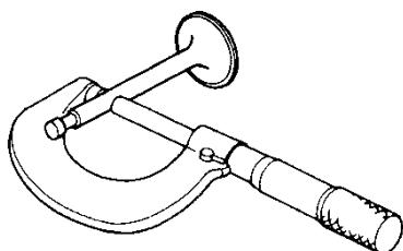
Utilisez un micromètre pour mesurer le diamètre externe de la tige de la soupape. Reportez-vous au tableau suivant.
