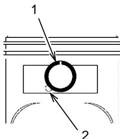
Installez l'attache de l'axe du piston (1) dans la gorge du côté du piston. Utilisez une pince à long bec pour faire pivoter l'attache. N'alignez pas l'écart avec la découpe (2). Répétez l'opération de l'autre côté.
