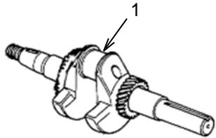
Vérifiez le diamètre de la portée du vilebrequin (1). Un diamètre normal est compris entre 29,975 et 29,991 mm. Si le diamètre est inférieur ou égal à 29,92 mm, remplacez le vilebrequin.
