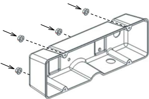
Coloque la parte frontal del panel de control sobre una superficie que permita proteger el panel de cualquier daño. Retire las 4 tuercas de 7 mm de la parte trasera de la carcasa del panel de control y cuidadosamente separe la carcasa del panel frontal.
