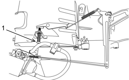
La velocidad máxima para el motor es de 3730 – 3830 rpm. Gire el tornillo de ajuste (1) en el sentido de las manecillas del reloj para aumentar la velocidad del motor. Gire el tornillo de ajuste en sentido contrario a las manecillas del reloj para disminuir la velocidad del motor.
