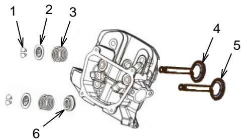
**Remarque :** Ne retirez pas les bagues d'arrêt (2) tant que la culasse est encore sur le moteur pour éviter que les soupapes glissent dans le cylindre.
