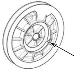
Coloque el gancho externo del resorte del arrancador retráctil en la ranura de la polea del arrancador y sostenga la polea en su lugar.
