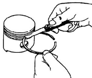
Mida la distancia del anillo, como se muestra. La distancia normal para el RP5500 es entre 0.015 – 0.045 mm. La distancia normal para el RP6500E y RP7500E es entre 0.030 y 0.060 mm.
