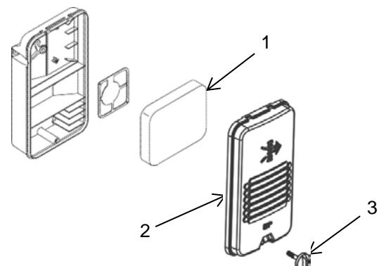
Quite el tornillo de la cubierta del filtro de aire (3) y la cubierta del filtro de aire (2). Verifique que el filtro de aire (1) esté limpio y sin daños. Si el filtro de aire está sucio, lávelo. Si el filtro de aire está dañado, sustitúyalo.
