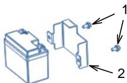
Desconecte de la batería el cable de batería negativo y asegúrelo para que no entre en contacto con la batería. Desconecte el cable de batería positivo. Use un voltímetro o un multímetro ajustado a VDC para medir la batería. Si la batería tiene menos de 12.4 voltios, reemplácela. Retire los tornillos (1) y la placa (2). Retire la batería y deséchela adecuadamente.
