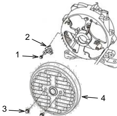
Retire los tornillos (3) y retire la cubierta del motor (4).
