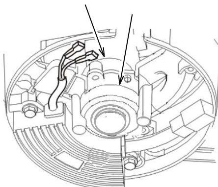
Retirez la brosse. Utilisez un ohmmètre ou un multimètre pour mesurer la résistance de la bague collectrice aux points indiqués. La résistance doit être de  $58,5 \Omega \pm 10\%$  à  $25^\circ\text{C}$ . Si la résistance est hors du seuil de tolérance, nettoyez la bague collectrice et réessayez. Si nécessaire, remplacez le générateur.
