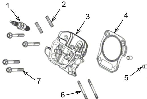
Retirez la bougie d'allumage (1). Dévissez les boulons de la culasse (7), puis retirez la culasse (3). Retirez la rondelle de la culasse (4) et jetez la rondelle usée. Retirez les pions de centrage (5) et mettez-les de côté. Pour cette procédure, les goujons (2) et (6) peuvent rester dans la culasse.
