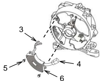
Débranchez tous les fils (3) de la brosse et le connecteur (4). Dévissez les boulons (5), puis retirez le régulateur de tension (6). Remontez les pièces dans l'ordre inverse. Le fil rouge va dans la borne « + » de la brosse. Le fil blanc va dans la borne « - » de la brosse.
