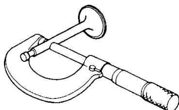
Use un micrómetro para medir el diámetro externo del vástago de la válvula. Consulte la siguiente tabla.
