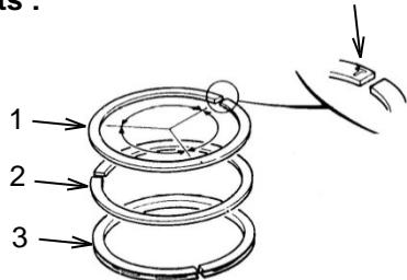
Les segments de piston comportent une marque à côté de la coupe. Utilisez un dispositif de tirage de bague pour installer les segments de telle sorte que la marque soit tournée vers le haut du piston. Assurez-vous que les segments sont installés dans les gorges appropriées :
