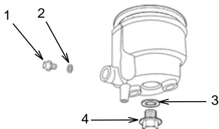
Installez le bouchon de vidange (1) et le joint (2) dans la cuve. Placez la cuve à niveau constant de façon à ce que le boulon de vidange puisse être accessible depuis l'extérieur de l'unité. Installez le joint (3) et le boulon (4) de façon à maintenir la cuve en place.
