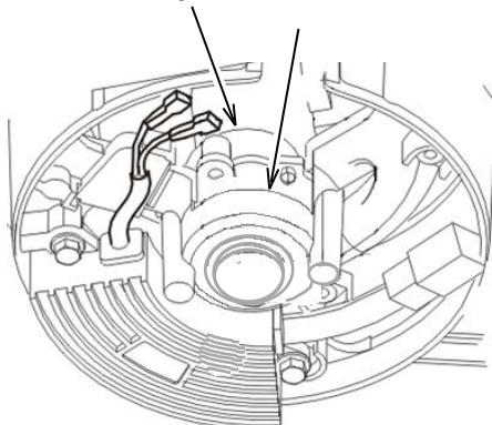
Retire la escobilla. Use un ohmímetro o multímetro para medir la resistencia del anillo colector en los puntos mostrados. La resistencia debe ser  $58.5 \Omega \pm 10\%$  a  $25^\circ\text{C}$ . Si la resistencia está fuera del margen de tolerancia, limpie el anillo colector y haga la prueba de nuevo. Reemplace el generador de ser necesario.
