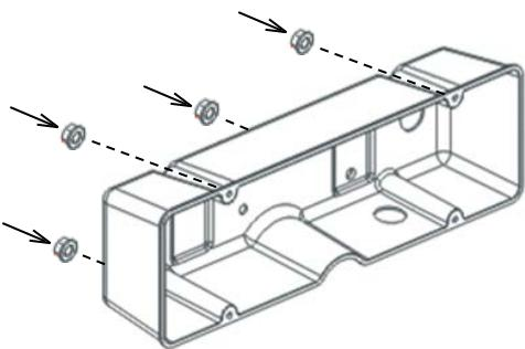
Placez la partie avant du panneau de commande sur une surface qui le protègera de tout dommage. Retirez les quatre écrous de 7 mm de l'arrière du boîtier du panneau de commande et séparez soigneusement le boîtier de la partie avant du panneau.
