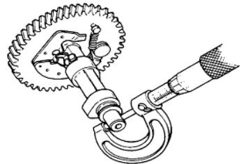
Mesurez le diamètre extérieur de l'arbre à cames. Les limites acceptables de diamètre sont répertoriées dans le tableau ci-dessous. Si le diamètre est en dehors de la plage acceptable, remplacez l'arbre à cames.
