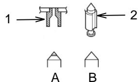
Revise el asiento de la válvula del flotador (1) y la válvula del flotador (2) en busca de desgaste. La Figura A muestra una válvula de flotador desgastada que necesita reemplazo. La figura B muestra una válvula de flotador que puede seguir siendo utilizada.
