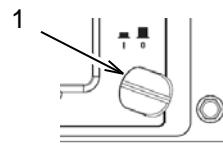
La luz del panel (1) está fijada al panel mediante pegamento de fusión en caliente. Desconecte la luz del panel del cableado y quite el pegamento. Retire la luz del panel de la parte frontal del panel.
