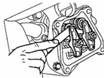
Mesurez le jeu de la soupape à l'aide d'une jauge d'épaisseur. Consultez le tableau suivant.
