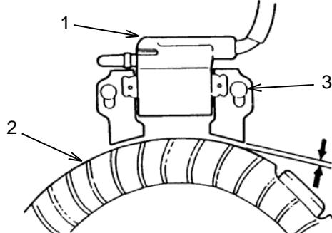
Utilisez une jauge d'épaisseur pour mesurer le jeu entre la bobine d'allumage (1) et le volant d'inertie (2). Pour le modèle RP5500, le jeu doit être compris entre 0,2 et 0,6 mm. Pour les modèles RP6500E et RP7500E, le jeu doit être compris entre 0,4 et 0,6 mm. Si le jeu se trouve hors de la plage acceptable, desserrez les vis (3) et réglez la bobine pour que le jeu soit dans la plage. Resserrez les vis.
