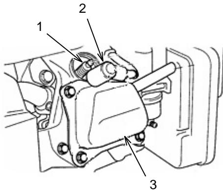
Retire el capuchón de la bujía (2), la bujía (1), la tapa de la válvula (3) y la junta de la tapa de la válvula. Jale ligeramente el arrancador retráctil hasta que el pistón quede en el punto muerto superior.
