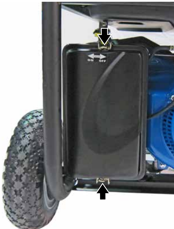
Figura 30 – Remoción de la Tapa del Filtro de Aire
