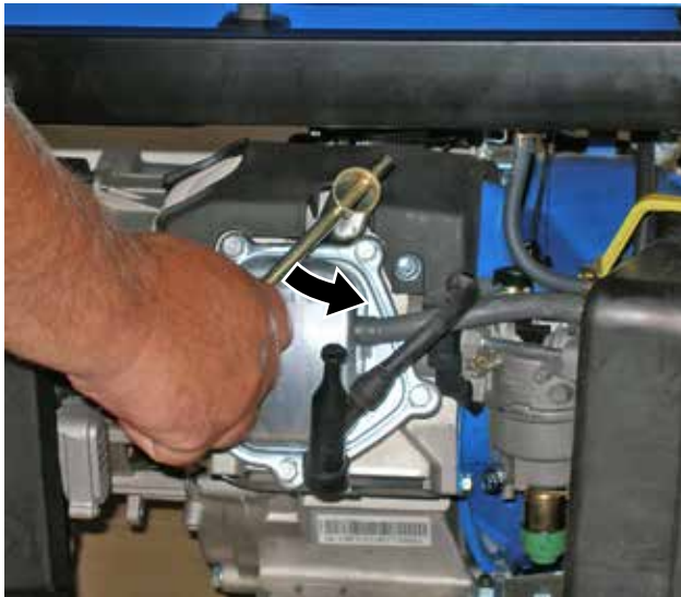
Figura 37 – Procedimiento para extraer la bujía
