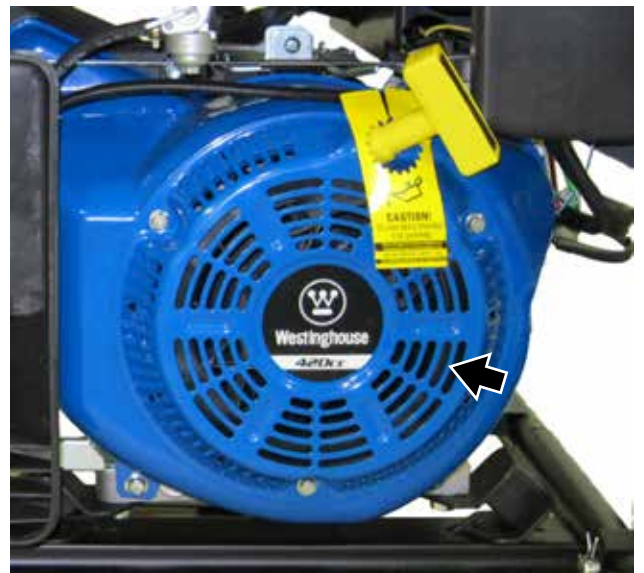
Figura 43 – Orificios de entrada y salida de aire del motor
