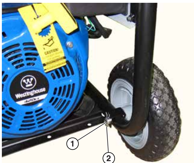
Figura 6 – Ensamble las ruedas al bastidor
