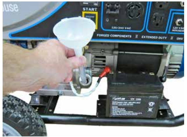
Figura 28 – Procedimiento para agregar el aceite del motor
