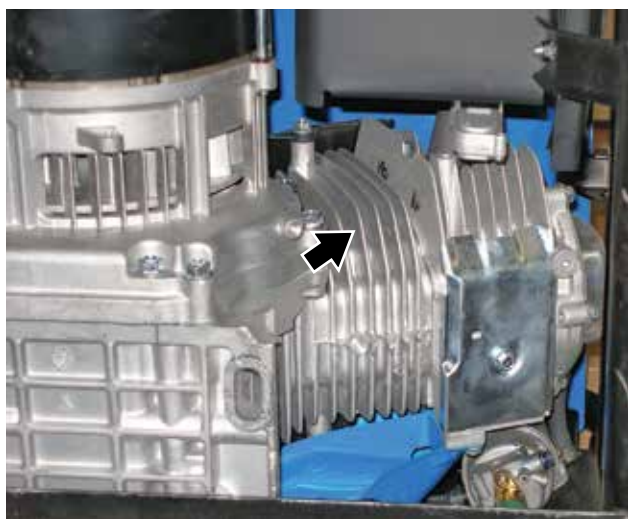
Figura 44 – Aletas de refrigeración del motor
