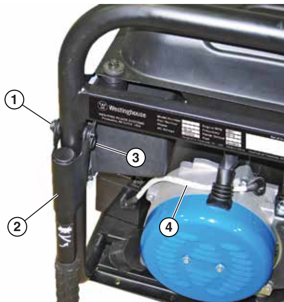
Figura 7 – Colocación de las manijas
