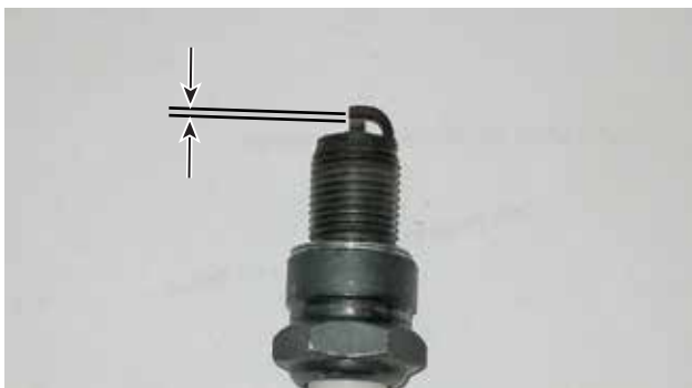
Figura 38 – Requisitos de separación de la bujía
