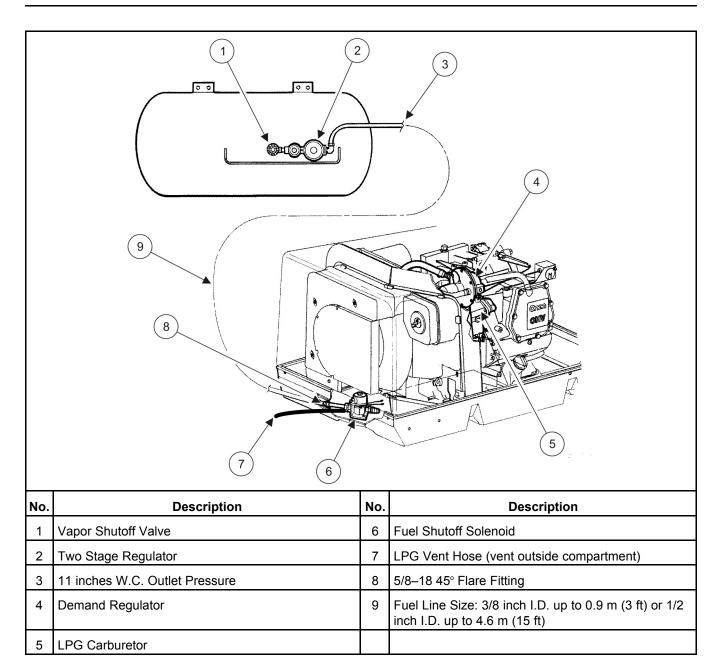
FIGURE 21. TYPICAL LPG VAPOR WITHDRAWAL FUEL SYSTEM
