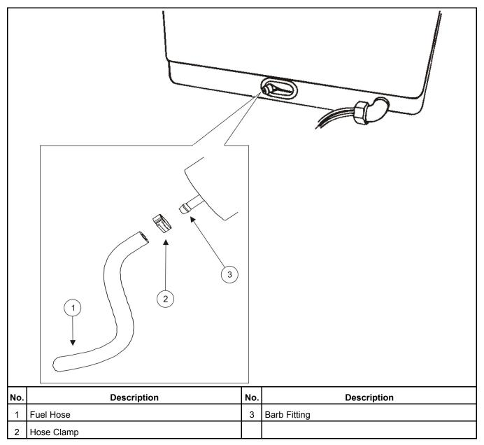
FIGURE 16. GASOLINE MOTORIZED FUEL CONNECTION
