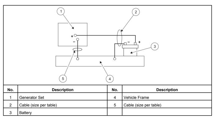
FIGURE 27. VEHICLE FRAME AS PATH FROM BATTERY NEGATIVE (-) TERMINAL
