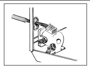
FIGURE 24. REMOTE CONTROL CONNECTOR
