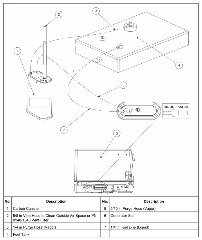
FIGURE 18. GASOLINE NONMOTORIZED (EVAP) CONNECTIONS
